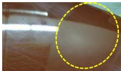
Рис. 2 Царапины удалены с помощью фена (обведенная зона)
